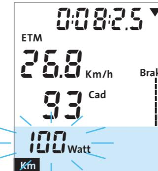
Når du trykker på SET, begynder hældningen at blinke. Hvis du trykker på SET igen, begynder styrkeindstillingen at blinke. Du kan justere denne indstilling vha. Piletasterne. Tryk på MODE for at bekræfte indstillingen.
