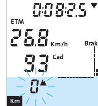
Cyklocomputer Flow umožňuje trénovat podle sklonu (%) a výkonu (Watt). Sklon využívá tréninkových válců a je nastavitelný ve 14 krocích od -4 do +9 (-4 je ekvivalentní skutečnému klesání s hodnotou 4 % a totéž platí pro 9% stoupání). Během tréninku na výkon upravuje počítač odpor válců tak, abyste museli šlapat zvoleným výkonem. Výkon můžete nastavit od 10 do 990 wattů v krocích po 10 wattech.
