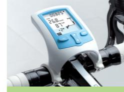
Med Flow kan du trenere i form av stigninger (%) og kraft (watt). Stigninger bruker sylinderen på sykkelrullen og kan justeres i 14 trinn fra -4 til +9 (-4 tilsvarer en faktisk nedoverhelling på 4 % og +9 tilsvarer en oppstigning på 9 %). Under krafttrening justerer sykkelcomputeren motstanden i sylinderen, slik at du altid sykler med den kraftinnstillingen du har valgt. Du kan stille inn denne fra 10 til 990 watt i trinn på 10 watt.
