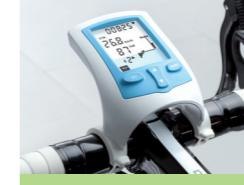
Med Flow kan du träna i backe (lutningsvinkel %) och efter effekt (Watt). Backe använder cykeltränarens cylinder och kan justeras i 14 steg från -4 till +9 (-4 motsvarar en faktisk nedförsbacke på 4 % och detsamma gäller 9 % uppörsbacke). Vid effekträning justerar datorn cylinderns motstånd, så att du alltid cyklar med vald effektinställning. Du kan ställa in detta från 10 till 990 Watt, i steg om 10 Watt.
