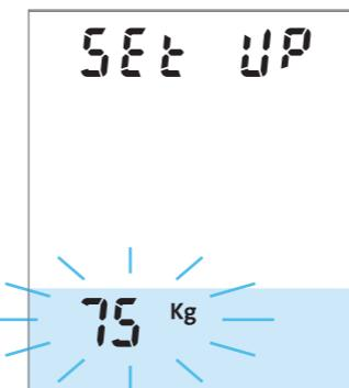
Po włożeniu wtyczki do gniazdka cały wyświetlacz zostaje na krótko testowo podświetlony. Następnie przez dwie sekundy wyświetlane są różne parametry:
