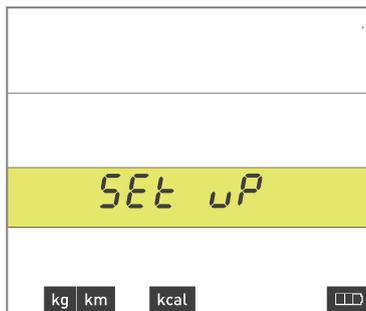
Εάν θέλετε να αλλάξετε τις ρυθμίσεις, πατήστε τα πλήκτρα Επάνω βέλος και Κάτω βέλος ταυτόχρονα για 3 δευτερόλεπτα. Θα φωτιστεί ολόκληρη η οθόνη και, αφού πατήσετε OK, θα μεταβείτε σε κατάσταση διαμόρφωσης (SET UP).
