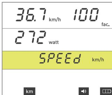
Přesnost zobrazení výkonu na cyklocomputeru i-Vortex závisí kromě jiného na tlaku válců na pneumatiku, tlaku v pneumatikách, proměnlivých silách magnetů a kolísání napětí. Aby bylo zaručeno správné měření výkonu, musíte kalibrovat brzdu. Pro optimální kalibraci doporučujeme, abyste jeli nejméně 3 minuty, aby se brzda řádně ohřála.
