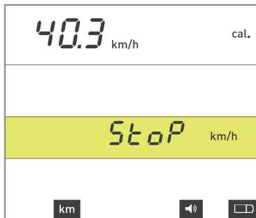
Dokładność pomiarów mocy na wyświetlaczu komputera i-Vortex zależy między innymi od nacisku rolki na oponę, ciśnienia w oponie, zmiennych sił magnesu oraz zmian napięcia zasilania. Aby zapewnić poprawność pomiarów mocy, konieczne jest przeprowadzenie kalibracji hamulca. Aby zapewnić optymalną kalibrację, należy pedałować przez co najmniej 3 minuty, co spowoduje prawidłowe rozgrzanie hamulca.
