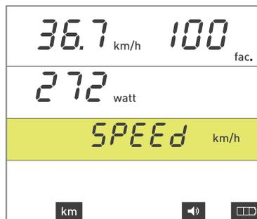
A eficácia das indicações de potência mostradas no ecrã do computador i-Vortex depende da pressão do rolo onde encaixa o pneu, da pressão dos pneus, das forças magnéticas variáveis, das variações de tensão na rede eléctrica, entre outros factores. Para garantir uma medição correcta da potência, é necessário calibrar o sistema de travões. Para obter a calibragem ideal, é aconselhável pedalar durante pelo menos 3 minutos, para aquecer adequadamente o sistema de travões.
